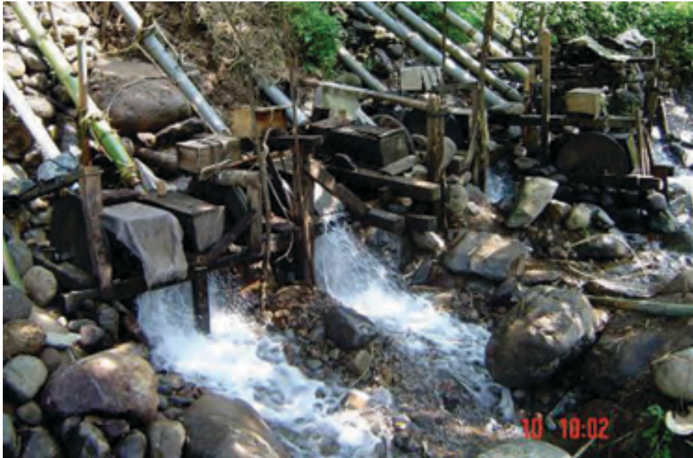
Gambar 12. Julantring , kincir air pembangkit listrik yang teknologinya sangat dikuasai oleh masyarakat Gn Simpang.
